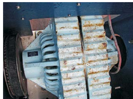
Magnetic particle clutch (částicová třecí elektromagnetická spojka) firmy MAGPOWER
