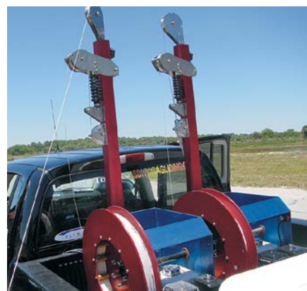
Odvíjčák založený na elektrických brzdách
